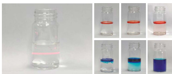
图 3 纳米乳液外观及类型判定
