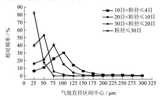
图 5 充气硬糖气泡的直径分布
