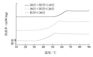
图 7 不同粒度充气硬糖的 DSC 曲线
