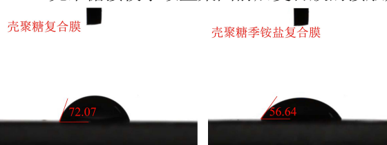
图 13 壳聚糖复合膜以及壳聚糖季铵盐复合膜接触角对比图
