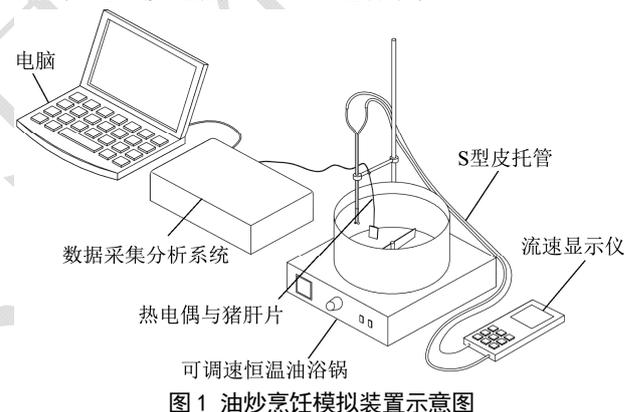
图1 油炒烹饪模拟装置示意图
