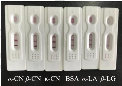
图9 \beta\text{-lg} 快速检测试纸条的特异性
