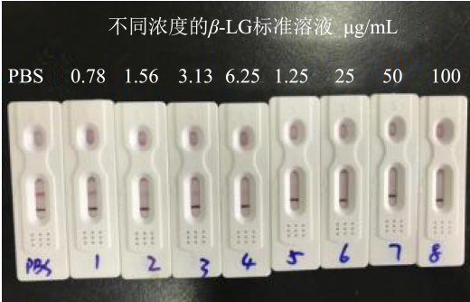
图8 \beta\text{-lg} 快速检测试纸条的灵敏度
