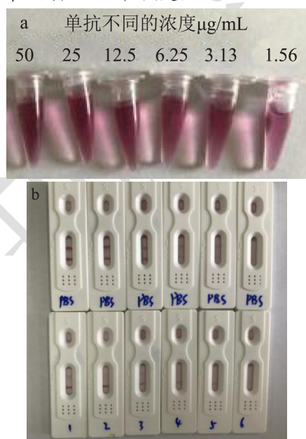
图6 胶体金标记 \beta -IgmAb 的最适抗体浓度的确定
