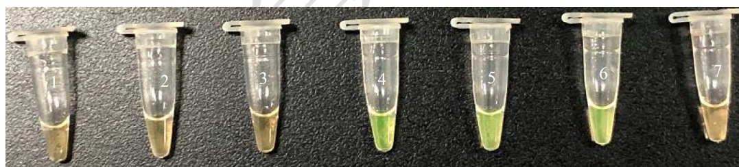
图2 LAMP 纯菌灵敏度实验结果
