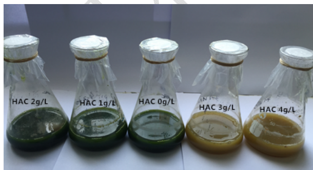
图3 补充醋酸对胶球藻 C-169 在脱色废水中生长影响
