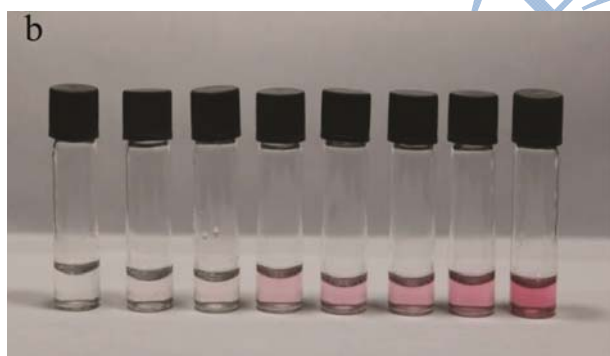
图 5 a 图为不同浓度的 AFB 1 的工作曲线, b 图为 AFB 1 浓度对应的颜色变化
