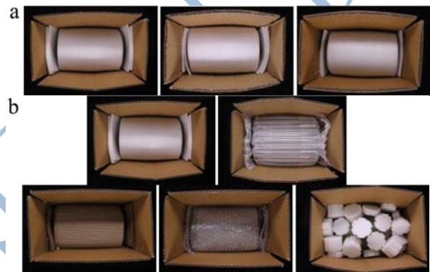
图 1 不同瓦楞纸箱层数 (a) 和填充物 (b) 包装哈密瓜示意图
