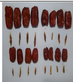
图 13 红枣去核模拟试验结果
