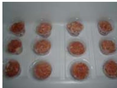
图7 肉糜水分损失测试样品
