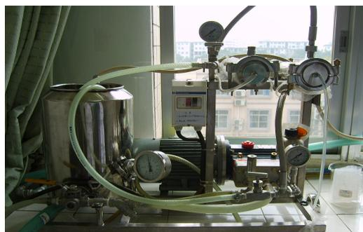
图2 纳滤膜实验装置图
