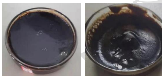
图8 真空干燥过程中样品形成的胶层
