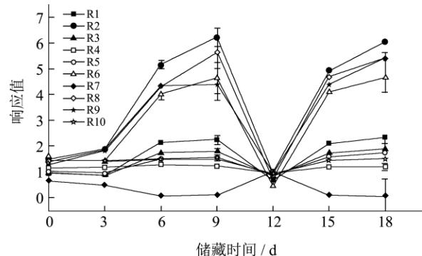
图 7 电子鼻传感器相应值变化图
