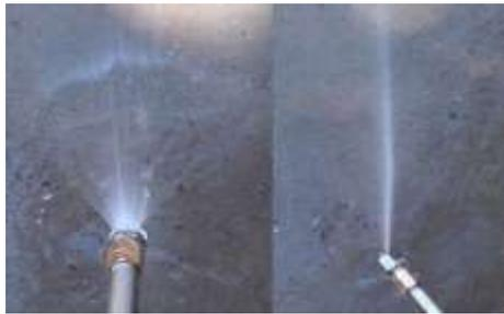
图 1 窄角扇形喷嘴纯水喷射图
