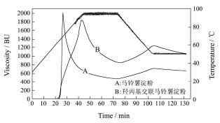
图 3 羟丙基交联马铃薯淀粉的黏度曲线 Fig.3 Viscosity curve of HP-CL
