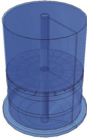
图6 半地下双层浅圆仓有限元模型
