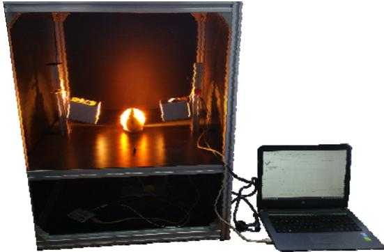
图1 近红外透射光谱采集系统
