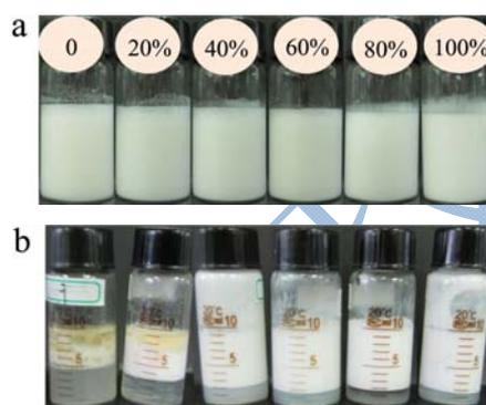
图 2 不同超声功率的 Pickering 乳液的外观
