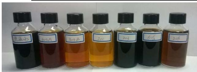
图1 剂量为4.0% (m/V) 的六种活性炭对酵母废水 (pH 4.35) 脱色效果的影响
