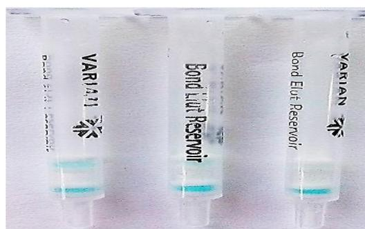
图 2 可视化凝胶检测柱检测味喃它酮代谢物衍生物 (NPAMOZ)
