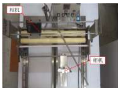
图 5 禽蛋轴向和翻转运动试验台
