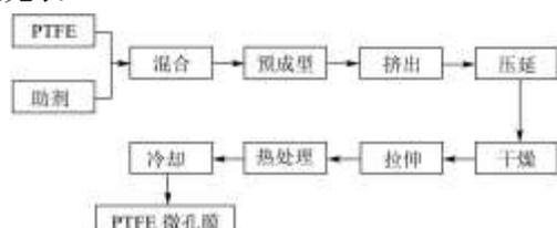
图 1 PTFE 微孔膜制备的工艺流程
